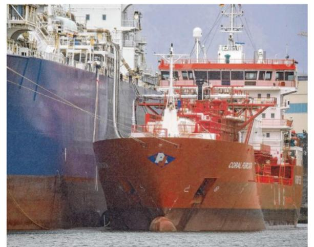
Der Tanker „Coral Furcata“ liegt im Industriehafen Lubmin am Terminal „Neptune“, einem Spezialschiff, das Flüssiggas speichern, erwärmen und gasförmig machen kann.
