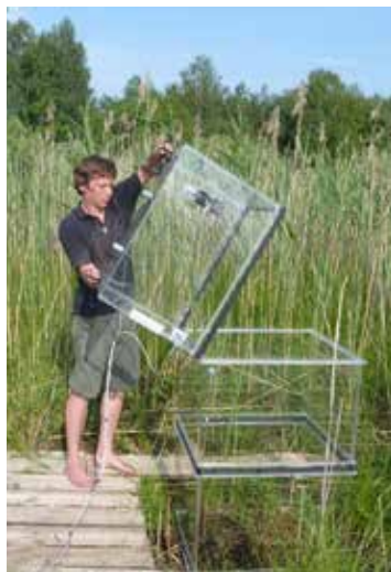
Рис. 29: Измерение парниковых газов на торфяном болоте. Фото: Фонд Михаэля Зуккова
